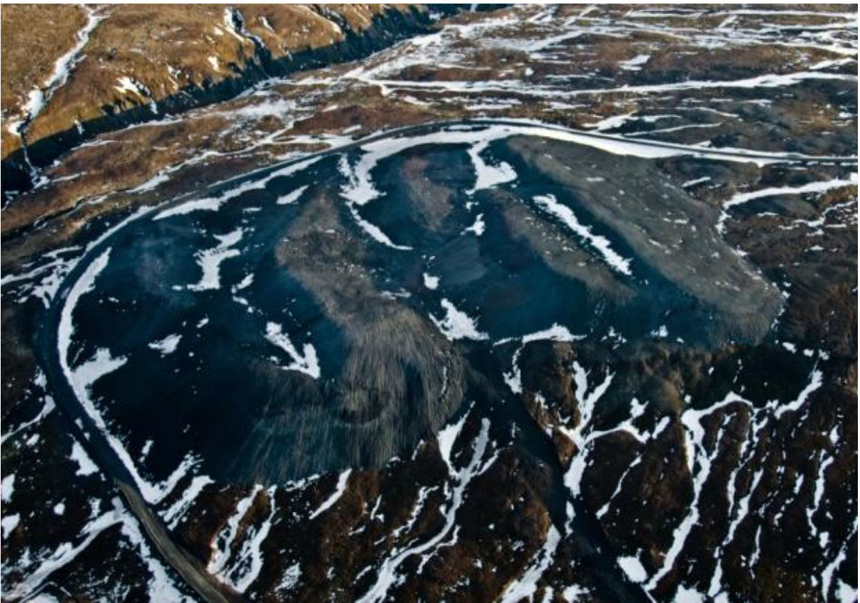
Haugsetningu lokið. Búið að grófmóta haugsvæðið og fjarlægja færiband. (05.11.2008)
